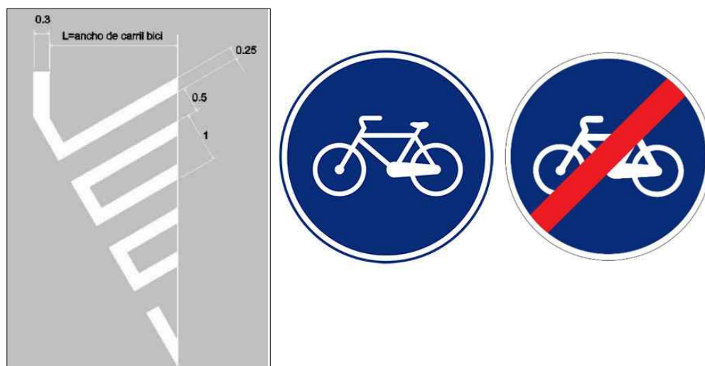
Gráfica 65. Señal horizontal (izquierda), señal vertical R-407a (centro) y señal vertical R-505 (derecha).
